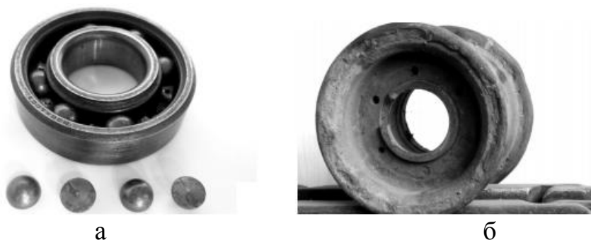
Рис. 3. Разрушение шарикового подшипника: а – разрушение тел, б - разрушение наружного кольца
