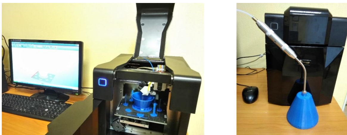
Рис. 3. Процесс изготовления и внешний вид насадки для газоанализатора
