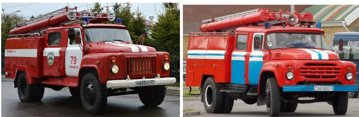
Рис. 4. Пожарная машина на базе автомобиля ГАЗ-53 и ЗИЛ-4314
