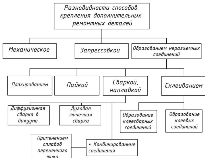
Рис. 1. Классификация способов крепления дополнительной и ремонтной деталей (* - комбинация способов сварки, комбинация сварки с запрессовкой)
