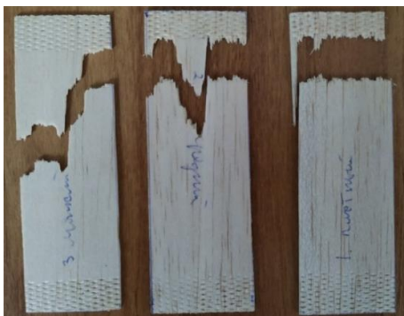
Рис. 2. Вид образцов после разрушения
