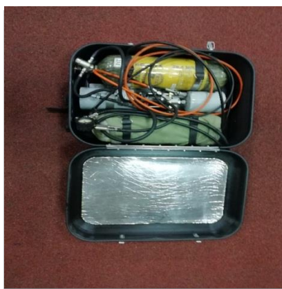
Рис. 2. Пневмогидравлический привод гидравлического аварийно-спасательного инструмента в раскрытом виде
