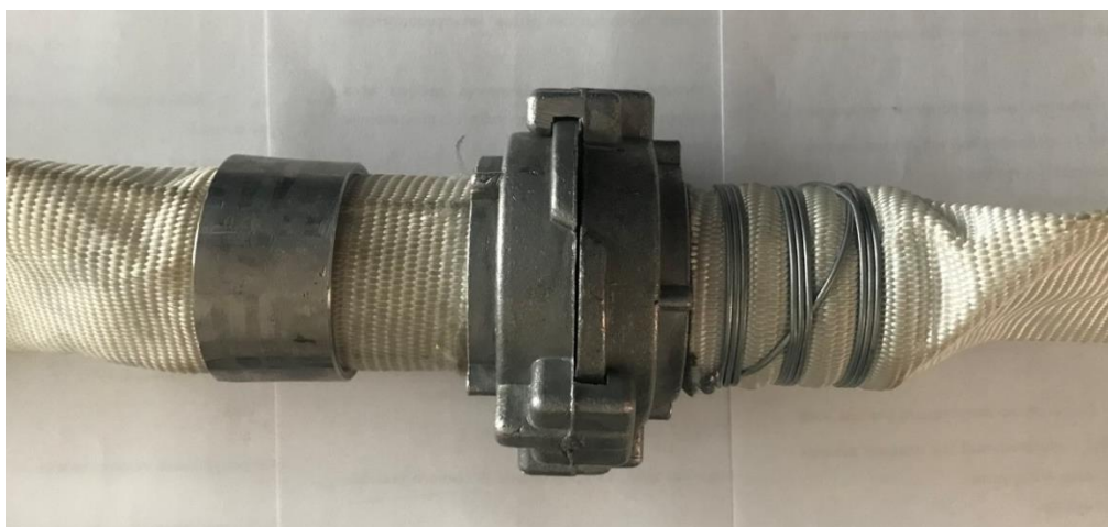
Рис.1. Натурный образец способа крепления пожарного рукава на соединительной головке (слева – новый способ, справа – традиционный способ)
