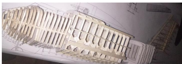
Рис. 1. Конструирование фюзеляжа авиамодели из бальзы
