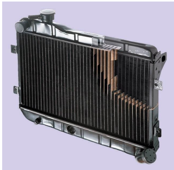
Рис. 2. Трубчато-ленточный радиатор с верхним и нижним расположением баков
