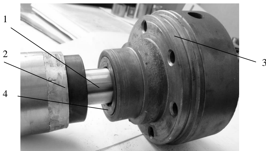
Рис. 1. Фотографии части электродвигателя: 1 – ротор; 2 – статор; 3 – щит подшипниковый; 4 – подшипник
