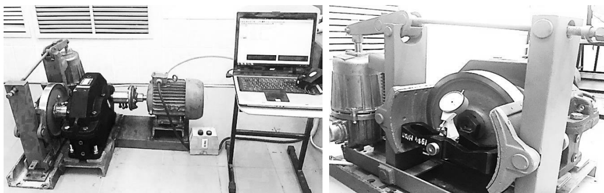
Рис. 2. Стенд испытания масел и СМ в зубчатом цилиндрическом редукторе
